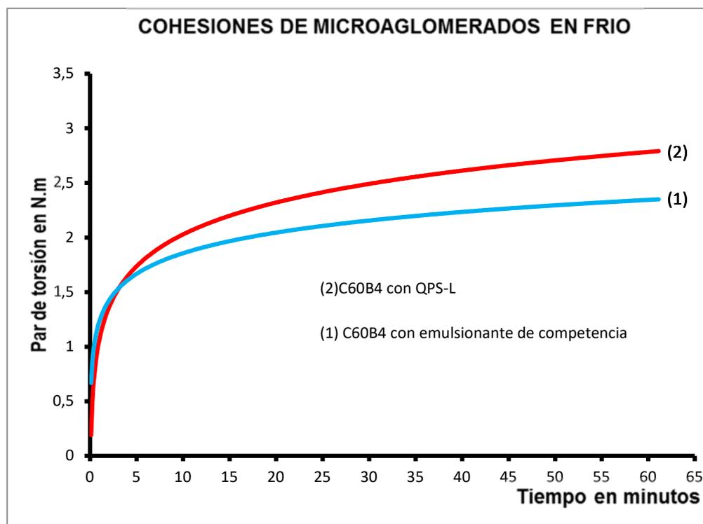
**POLYBIT QPS-L** es especialmente recomendable para la fabricación de emulsiones cuando se usa un betún asfáltico de baja calidad.
